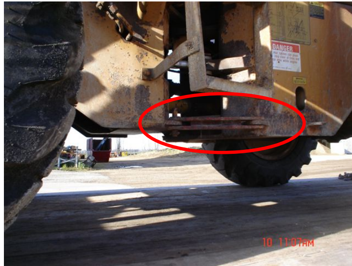
Véhicule équipé de goupilles de verrouillage
