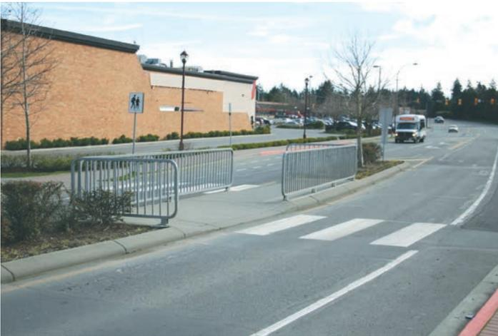
Figure 4.8 : Passage en deux segments décalés (modèle danois), photographie de David Coburn et Neil Arason
