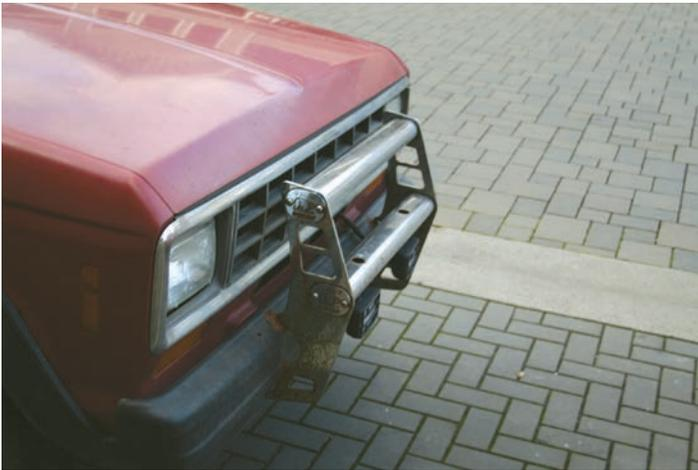
Figure 5.3 : Véhicule muni de bare-buffles, photographie de David Coburn et Neil Arason
