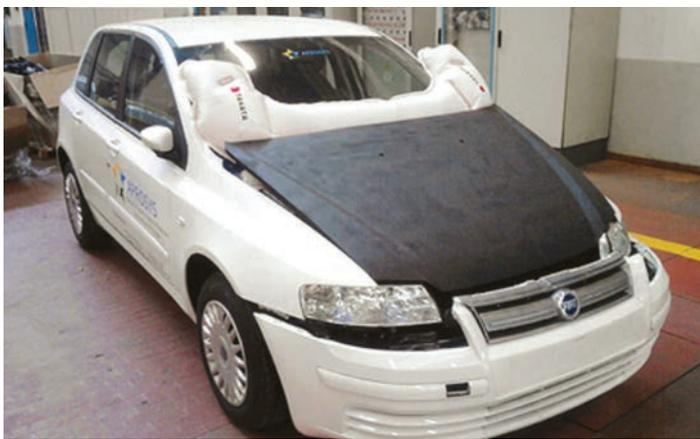
Figure 5.2 : Véhicule d'essai muni d'un coussin gonflable pour piétons et de caractéristiques de pointe
